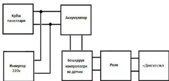
2-расм. Қуёш ҳаракатини автоматик кузатувчи (трекер) қурилмасининг блок-схемаси.
