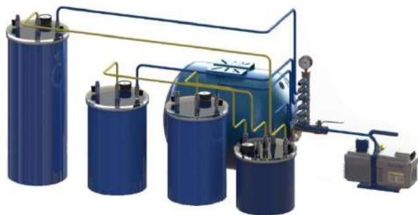
1-расм. Трансформатор мойини дегазация қилиш қурилмаси
