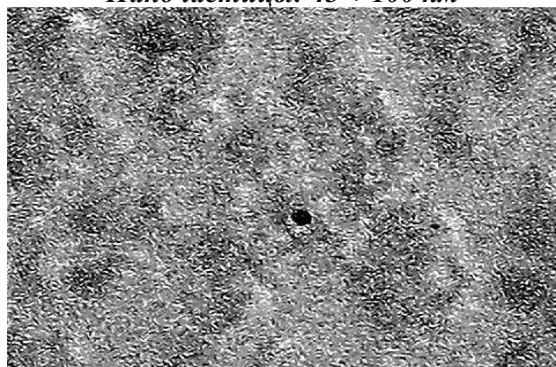
а) 0,1% раствор сульфат хитозана, осажденный в ацетоне. Наночастицы: 45 ÷ 100 нм
