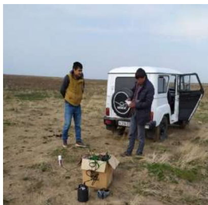
Расм 1. Шовқин даражасини ўрганиш жараёни (Guralp 6TD) ёрдамида
