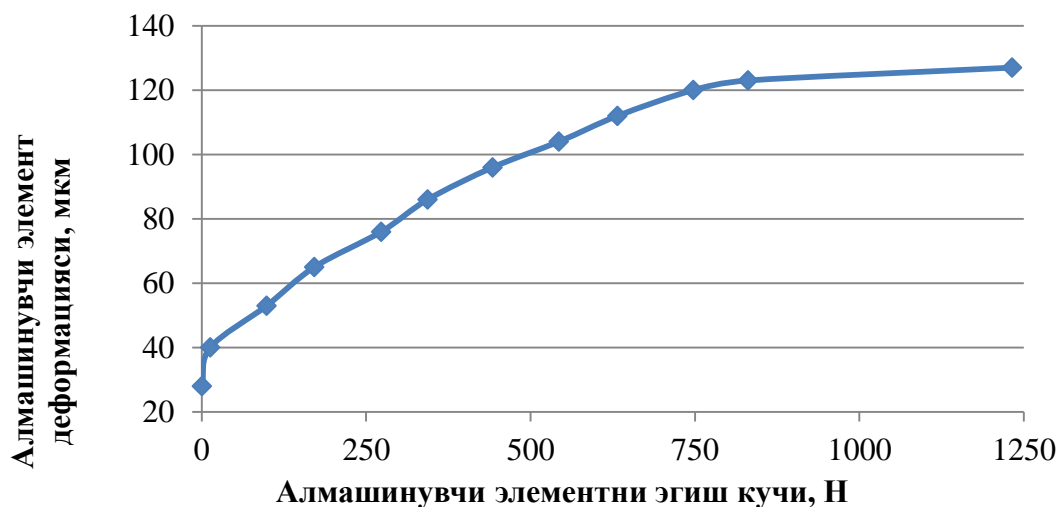
2- расм. Алмашинувчи элементни эгилиш деформациясининг эгиш кучига боғлиқ ўзгариш графиги
