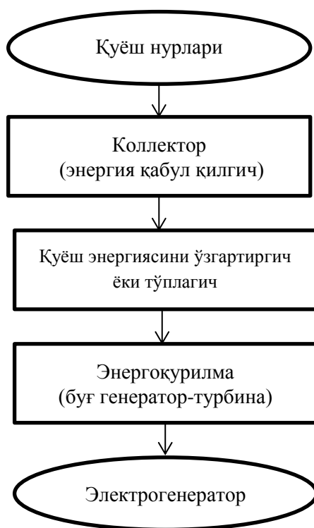
2-расм. Қуёш коллекторлари орқали электр энергия олиш схемаси.
