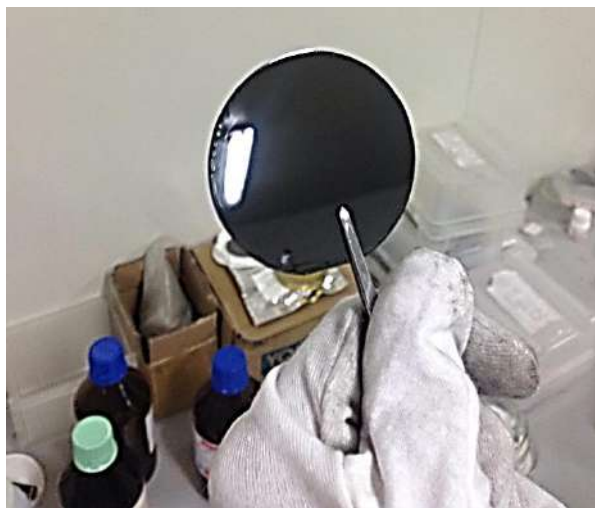
Рис.1. Общий вид готового базового слоя солнечного элемента
