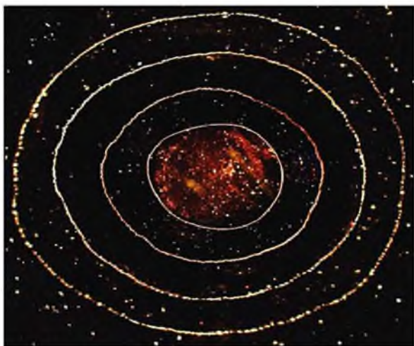
Рис.1. Конечная форма кольцевых структур нанокластеров nC_{60} , синтезированных на поверхности стеклянной подложки при термическом испарении растворителей при комнатной температуре. Снимок был получен при помощи оптического бинокулярного микроскопа марки «Motic B1-220A» с цифровой камерой.
