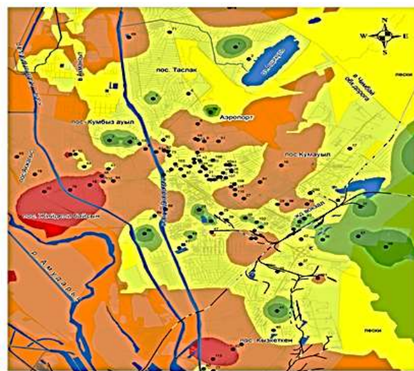
Рис.2 Карта-схема засоления грунтов г. Нукуса (до уровня подземных вод), % 1 - 0,026-0,33%; 2- 0,33-0,44%; 3- 0,44-0,74%; 4 - 0,74-1,59%; 5 - 1,59-3,98%; • - скважины
