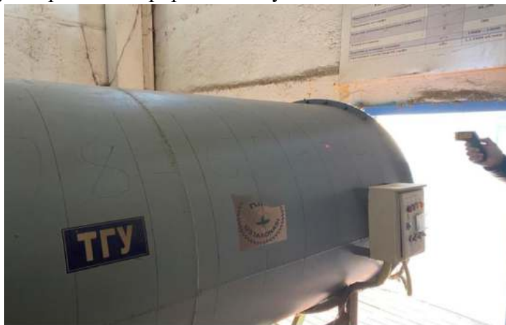
1-расм. Иссиқлик ишлаб чиқаргич ташқи корпусининг қизиб қолган ҳароратини ўлчаш жараёни.
