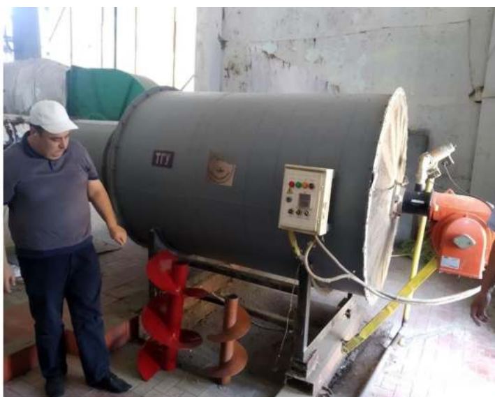
1-расм. ТГУ русумли иссиқлик генератори ва унинг ёниш камерасига ўрнатиладиган винтли мосламаларни кўриниши.
